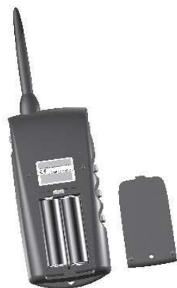
Sustitución de las pilas en el mando CANICOM 1500
