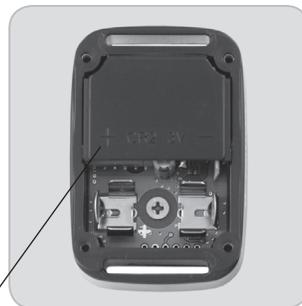
Indicación de la polaridad de la pila
